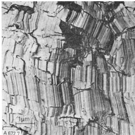
Abb. 7. Polyäthylenkristall aus gestreckten Ketten, elektronenmikroskopische Aufnahme einer Bruchfläche. Die Molekülketten liegen in der Bildebene, parallel zu den sichtbaren Streifen.
